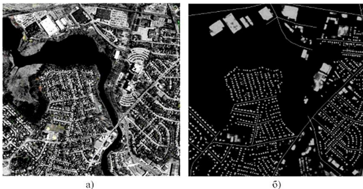
Рис. 3. Пример классификации спутникового изображения DCNN-методом [18]: а) исходное изображение; б) результат классификации (выделенные классы объектов: здания, дороги и фон)
