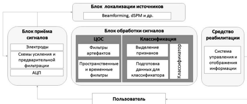
Рис. 1. Структурная схема адаптивного моторного ИМК
