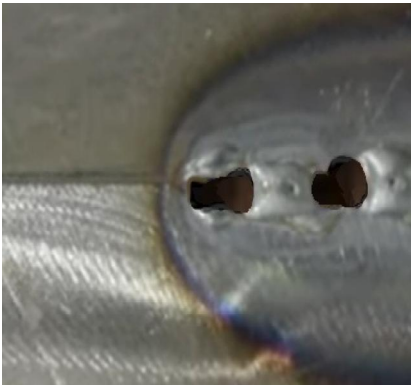
Рис. 1. Тестовое изображение прожога, истинная метка: Burn-through x 2, вывод модели: Burn-through, Porosity
